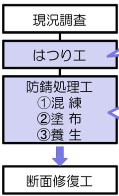
手はつり、ウォータージェットにてはつり落としした後、次の処理を行う。
