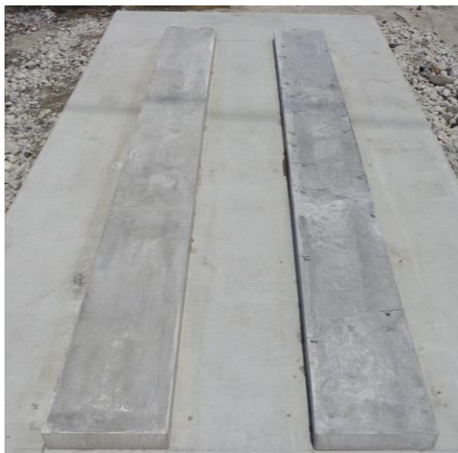
Fig.5. 試験供試体 1 ヶ月間暴露（左；デンカクロルフィックス GV、 右；市販無収縮モルタル）
