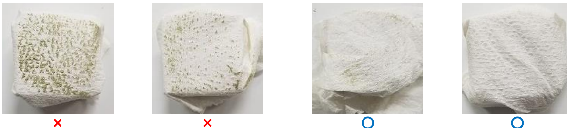
写真 3-1 保護塗装工に移る目安（接着剤の表面硬化状態）
