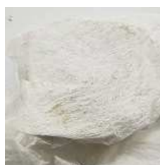
写真 3-1 保護塗装工に移る目安 (接着剤の表面硬化状態)
