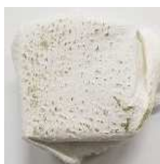
写真 3-1 保護塗装工に移る目安 (接着剤の表面硬化状態)
