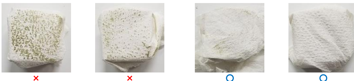
写真 3-1 保護塗装工に移る目安（接着剤の表面硬化状態）
