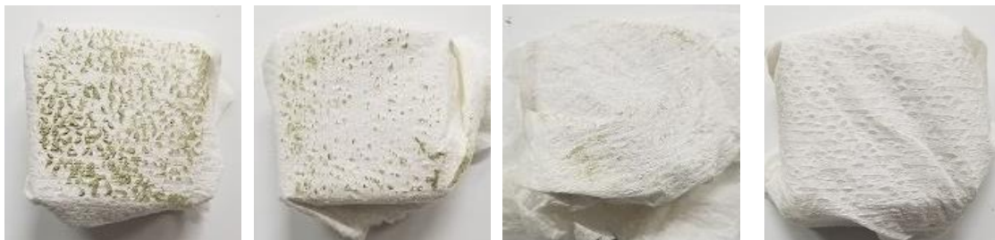
× × ○ ○ 写真1 上塗り剤の塗布に移る目安（接着剤の表面硬化状態）
