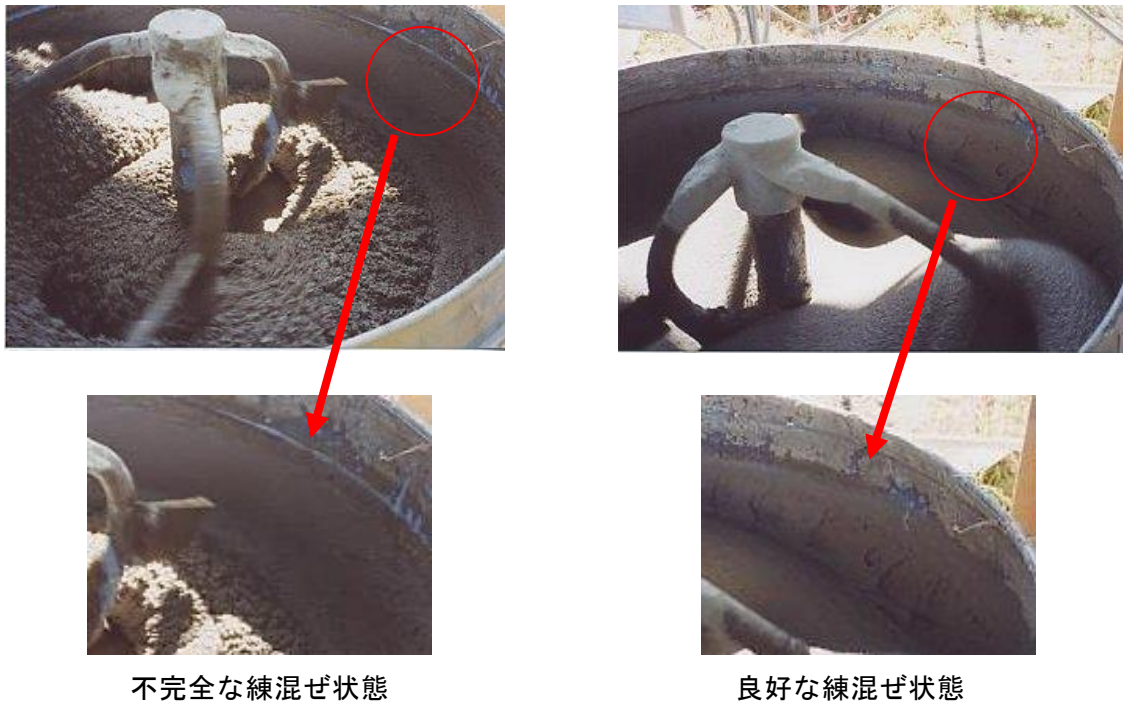
図-3 練混ぜ状態
