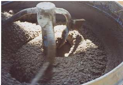
不完全な練混ぜ状態
