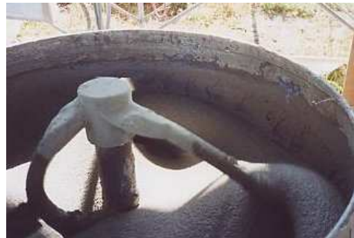
良好な練混ぜ状態
