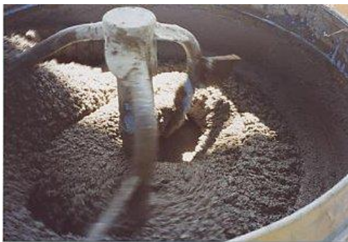
不完全な練混ぜ状態
