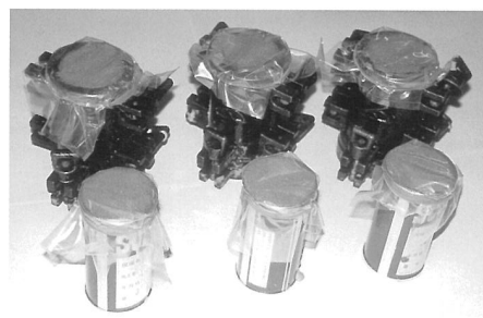
写真-6 供試体の作製例
