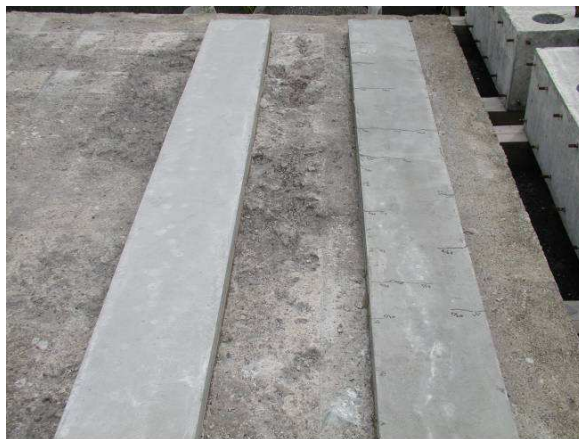
写真－1 試験供試体（左；プレタスコン TYPE-LS500，右；市販無収縮モルタル）
